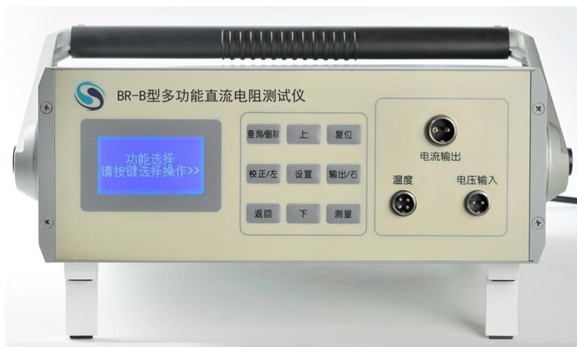
BR-B 型多功能直流电阻测试仪主要是为精密测量电线电缆导体电阻设计的，它可以达到 36 级电桥的测量精度，并测量环境温度，自动换算温度系数。可升级代替 QJ36、QJ57、QJ84、QJ44、SB2230、微欧计等传统设备。BR-B 是 BR-A 的简化版。
