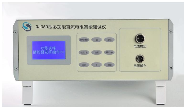
QJ36D 型多功能直流电阻智能测试仪主要是为精密测量电线电缆导体电阻、各种导体、半导体材料直流电阻、电机变压器直流电阻等设计的，它可以达到 QJ36、QJ19、QJ55 电桥的电阻测量精度，测量铜铝材料时可根据设置温度，自动换算温度系数。可升级代替 QJ36、QJ57、QJ84、QJ44、SB2230、PC36C、微欧计等传统设备。QJ36D 是 QJ36B 的简化版。
