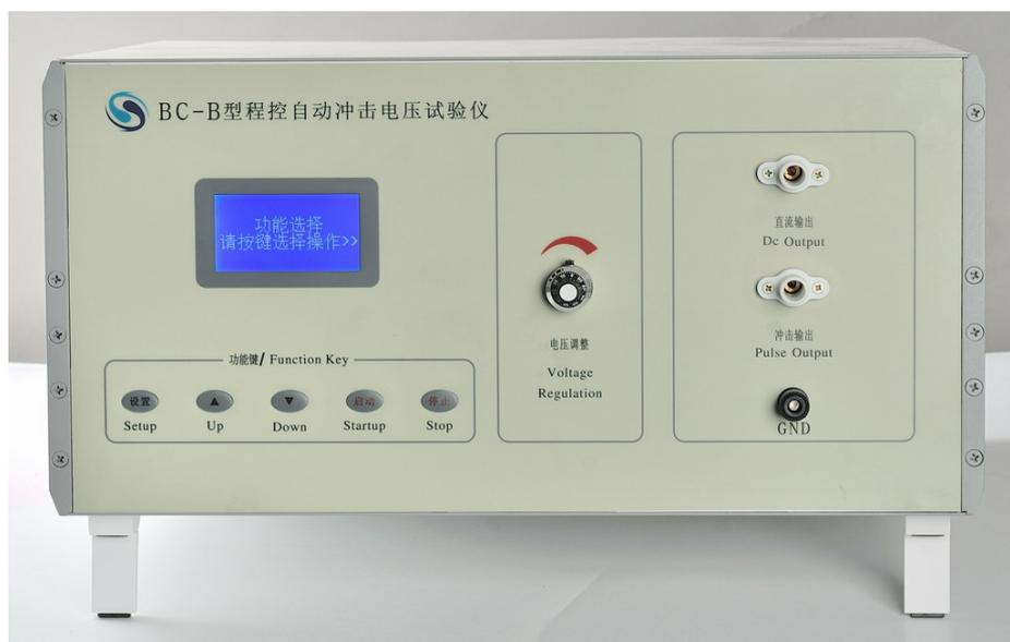
BC-B 型程控自动冲击电压试验仪主要是根据 TB/T 2653、GB/T22387、GB/T17626、GB/T17627、GB/T16927、GB14048、GB7251、GB/T16935、IEC61730、GB4706、GB3048、JB/T 7083 等标准要求，主要用于充电桩、新能源汽车、低压成套、低压电器、高低压开关、太阳能、电度表、继电器、漏电保护器等产品的安全性能（介电性能）检测。可通过计算机控制冲击输出、示波器波形采集，可打印生成测试报告。
